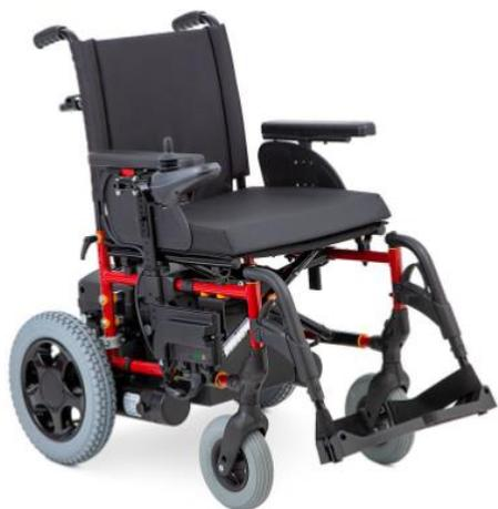
Кресло-коляска Sunrise Medical F35 с электроприводом имеет прочную складную раму. Удобные для пользователя функции, разумная стоимость и современный внешний вид делают коляску F35 отличным выбором для тех, кто нуждается в базовой мобильности и передвижении.
