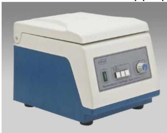
Корпус центрифуги изготовлен из ударопрочного АБС пластика, элементы барабана из нержавеющей стали. Держатель для пробирок выполнен в виде конусного диска. Мотор — переменного тока, что обеспечивает минимальный уровень шума. Система амортизации оборудована механизмом равновесия, который гасит нецентробежные импульсы. Работа центрифуги возможна только при закрытой крышке. Центрифуга оснащена регулятором частоты вращения и механическим таймером.
